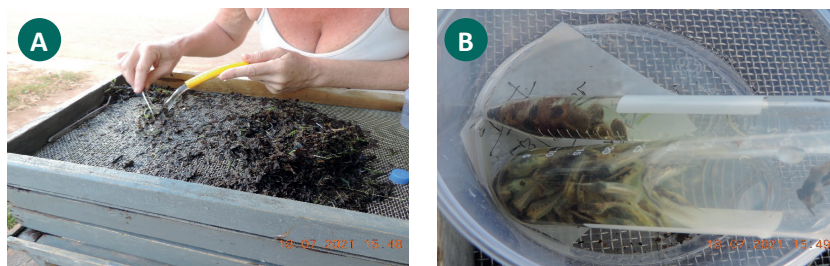
Figura 4 – Fotografias do processo de lavagem em sequência de peneiras de 2, 1 e 0,5 mm de amostras coletadas neste estudo
