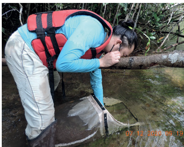
Figura 2 – Fotografia de pesquisador utilizando coletor tipo Surber em posição contra a corrente do rio, para coleta de macroinvertebrados bentônicos neste estudo
